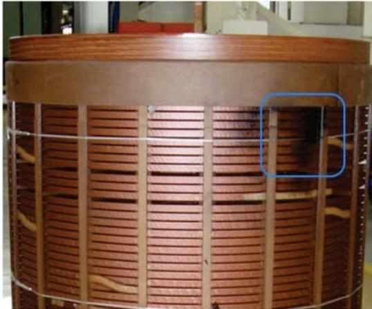
**Bild 5:** Schadensbild am Aktivteil: Durchschlag von US-Wicklung zum Kern durch das Isolationsmaterial hindurch
