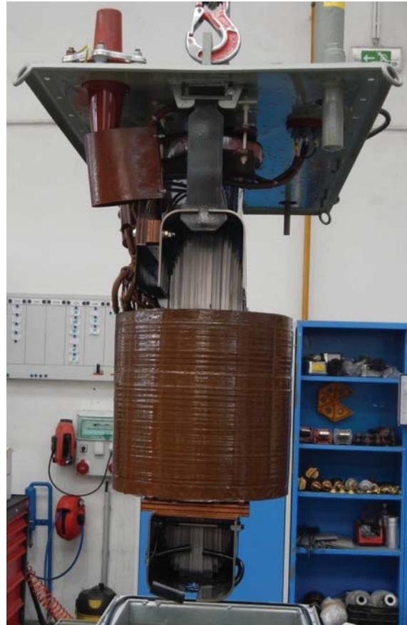
**Bild 12: Aktivteil des baugleichen Transformators, „altes“ Design. Keine axiale Verspannung.**
