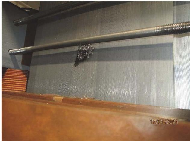
Lichtbogenspuren zwischen Kern und Anschlussbolzen
