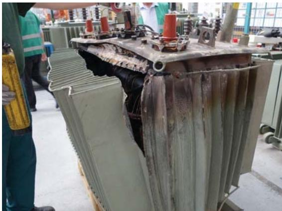
**Bild 11: Brandschaden und Aufgerissener Wellwandkessel.**
