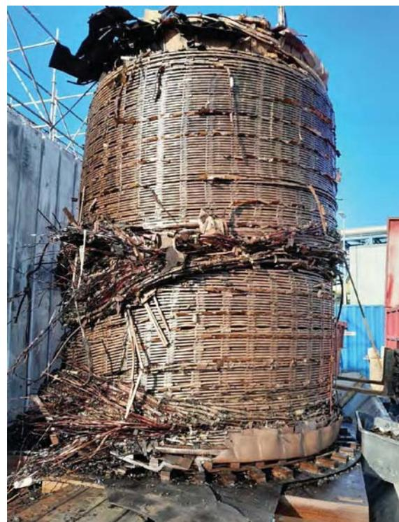
**Bild 9:** Beschädigte Hochspannungswicklung 1V.
