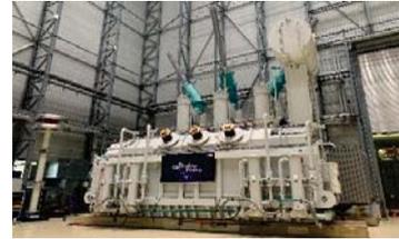
Maschinentransformator im Prüffeld des Transformatorwerks Nürnberg
