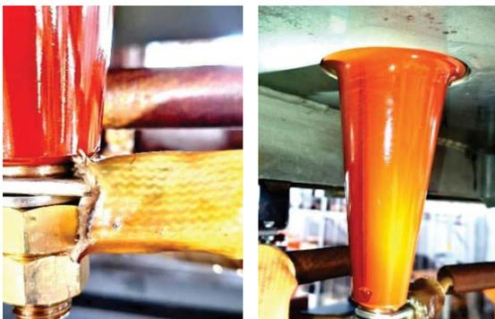
**Bild 14:** Entladungsspuren an Anschluss und Deckel
