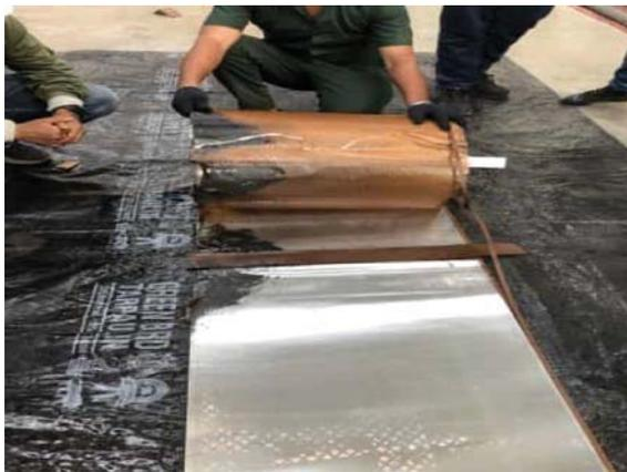
**Bild 4:** Abrollen der beschädigten US-Wicklung. Die Schadenstelle ist deutlich zu erkennen.
