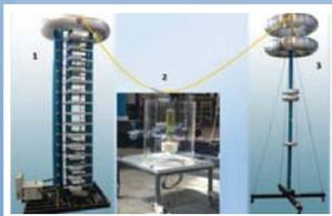
Zur Simulation von D-Fehlern im Labor werden die Isolierflüssigkeiten mit Blitzstoßspannung belastet. Gemäß IEC 60897 erfolgt der Test mittels Nadel-Kugel-Anordnung bei 25 mm Elektrodenabstand mit 10 Stößen.
