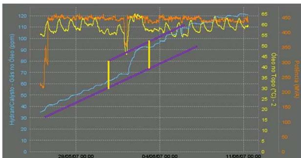
Das Online-Monitoring-System detektiert einen **anormalen Anstieg** der Fehlgas-Konzentration, durch **Korrelation** mit **Leistung** und **Hot-Spot Temperatur** sowie **Vergleich** mit den **anderen Transformatoren** (Phasen).
