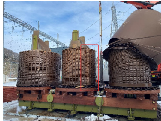
Bild 1: Post-mortem-Analyse von Einheit 397-1-2 (US-Wicklung Phase V mit radialer Deformation)
