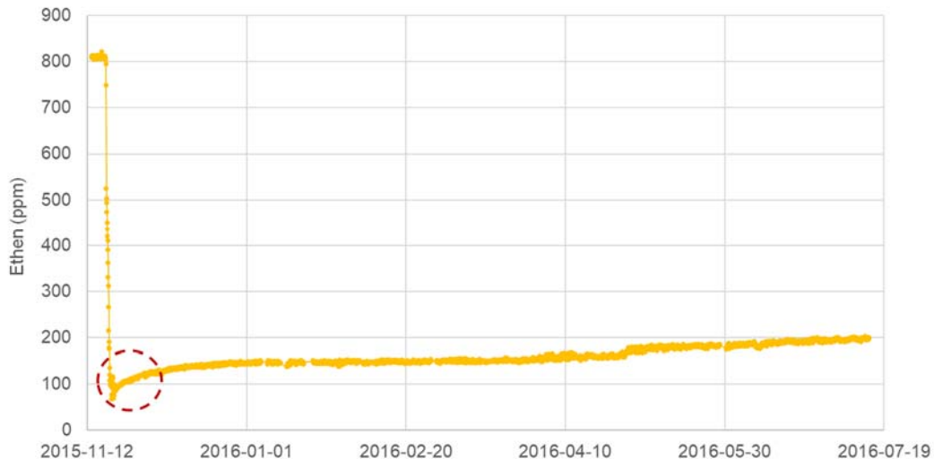
Abbildung 17. Zoom-Darstellung der Veränderung des Ethen-Gehalts unmittelbar nach der Entgasung des Transformators
