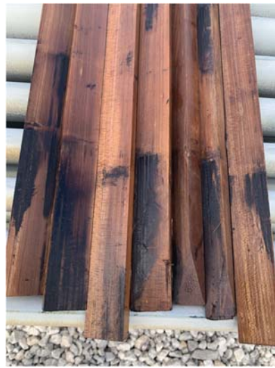
(b) Karbonisierung auf der inneren Oberfläche der Platzhalter aus Holz
