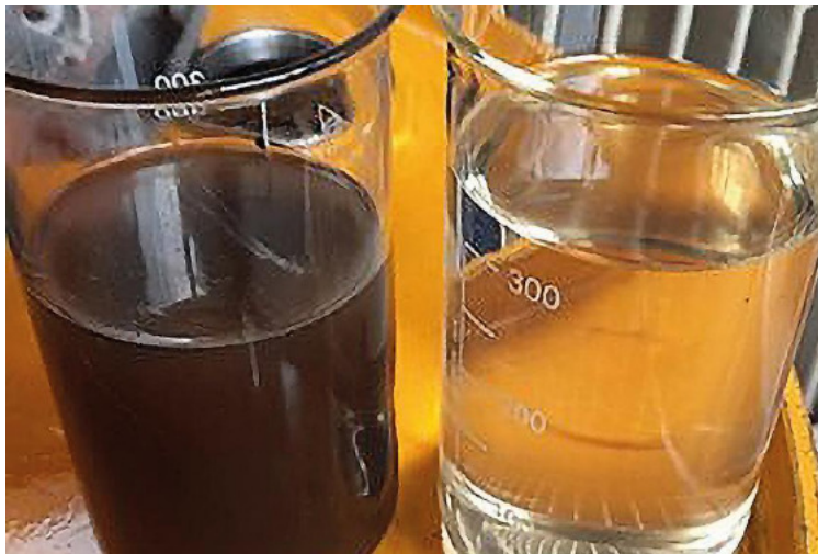
Bild 5: Ölproben vor (links) und nach (rechts) Inbetriebnahme des Filtersystems ES 2000. Das dunkle, schmutzige Öl wies einen hohen Gehalt an Schmutzpartikeln auf (Abrieb von Schleifringen) und führte zu schlammartigen, klebrigen Ablagerungen im Isoliersystem (Kerne etc.).
