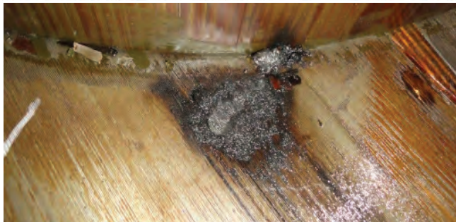
Beispiele für Heistellen an Kontakten und Kern
