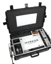
MYRKOS Portables Gas-in-Öl Analysegerät
