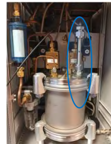
Integrierter Feuchtesensor in der Vakuumkammer der DGA
